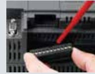
所有模块的输入输出端子可拆卸
