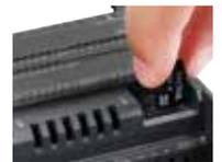
通用 Micro SD 卡，支持程序下载和 PLC 固件更新
